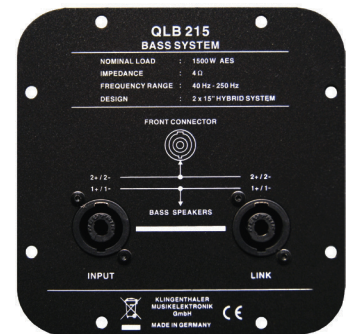
Anschlussfeld / Connector Speakon / Speakon
