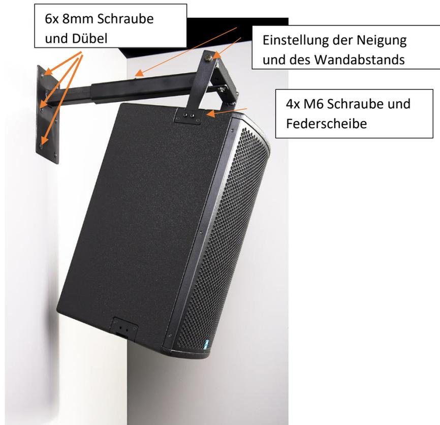
Zunächst wird die Multimounthalterung mithilfe sechs handelsüblicher Dübel (Stärke 8mm) und Schrauben an der Wand installiert.
