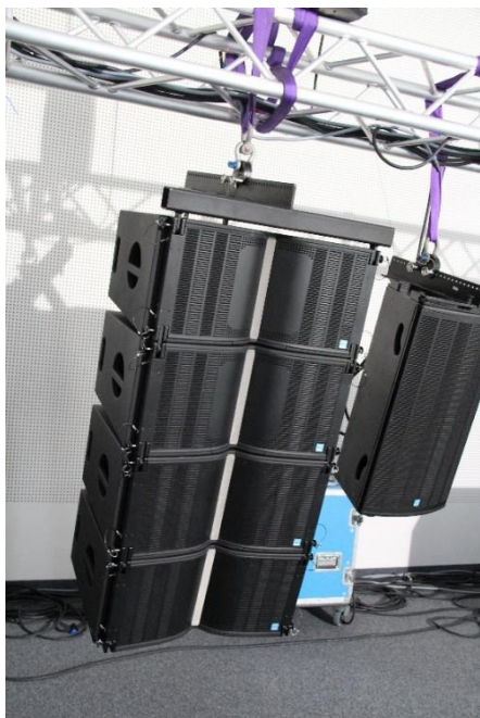
Abbildung 17: Array bestehend aus den ersten 4 Elementen
