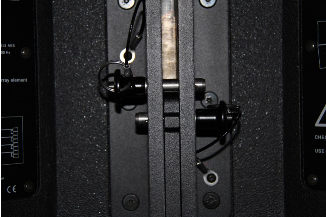
Abbildung 16: Korrekt angebrachter Sicherungspin direkt im darüberliegenden Safety Pin-Loch.
