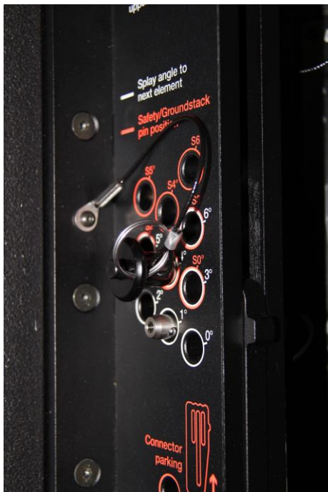
Abbildung 15: Korrekt gesetzter Sicherungs-Pin
